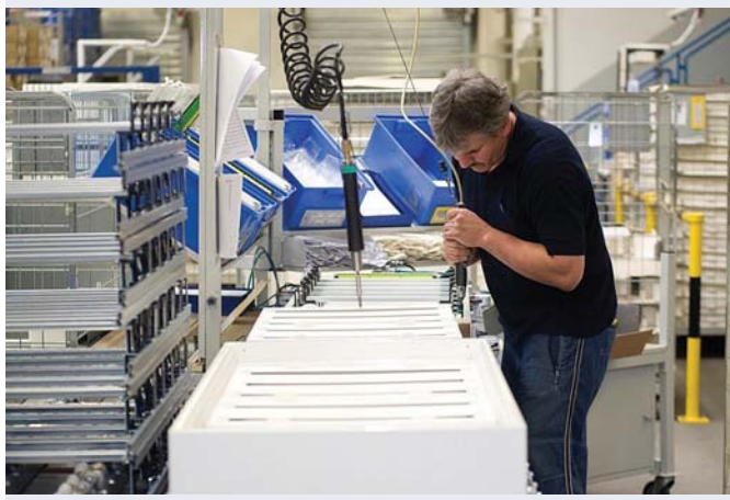
Участок сборки малых распределительных щитов
